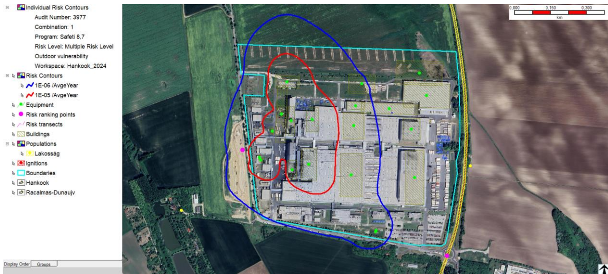
1. ábra: A halálozás egyéni kockázati görbéi – kék: 1E-6/év, piros: 1E-5/év – a telephelyen
