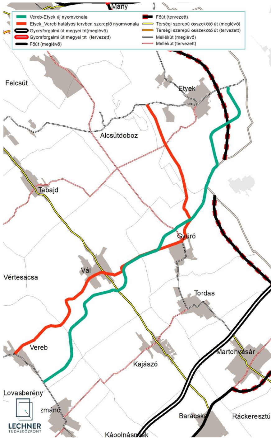
8. ábra: Etyek - Gyúró - Vál - Vereb tervezett nyomvonalának változása
